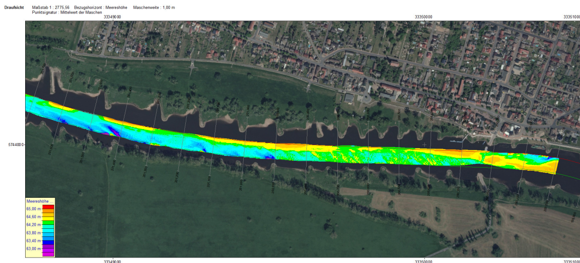
Abb. 1.1 Messdaten des Gewässerbodens im Bereich der Fahrrinne, aufgenommen mittels schiffsgestützter hydroakustischer Messverfahren (bereitgestellt von der Bundesanstalt für Gewässerkunde, BfG).
