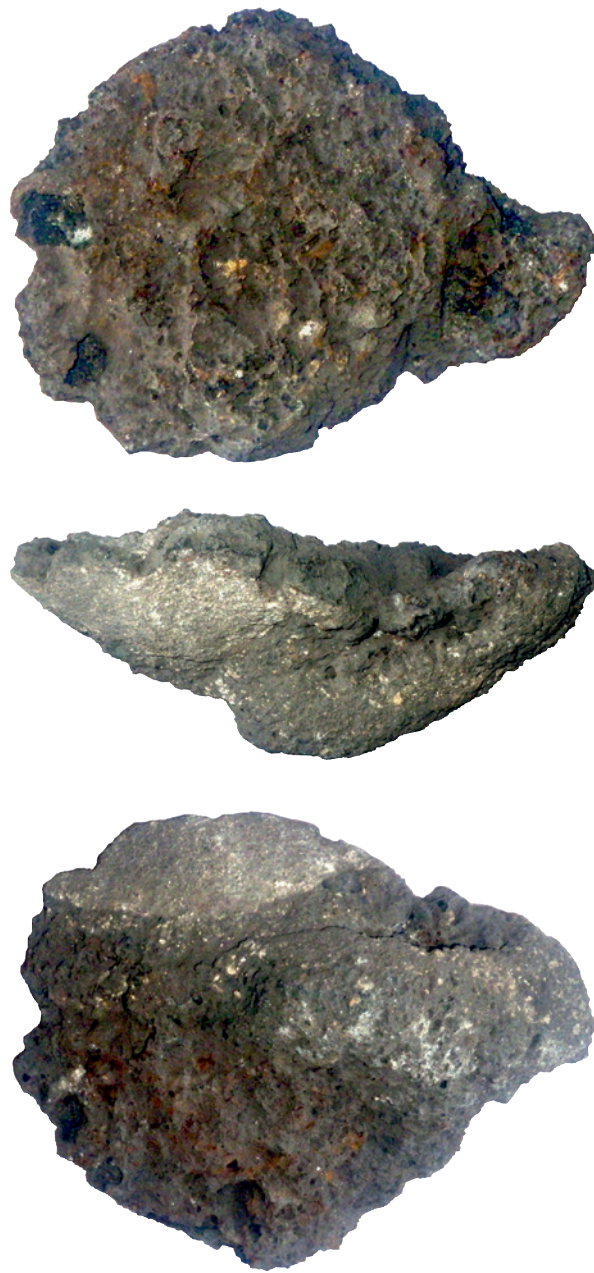
Abb. 2. Monte San Martino (Lomaso, Trentino). Planokonvexe Kalottenschlacke. – M 1:2.
