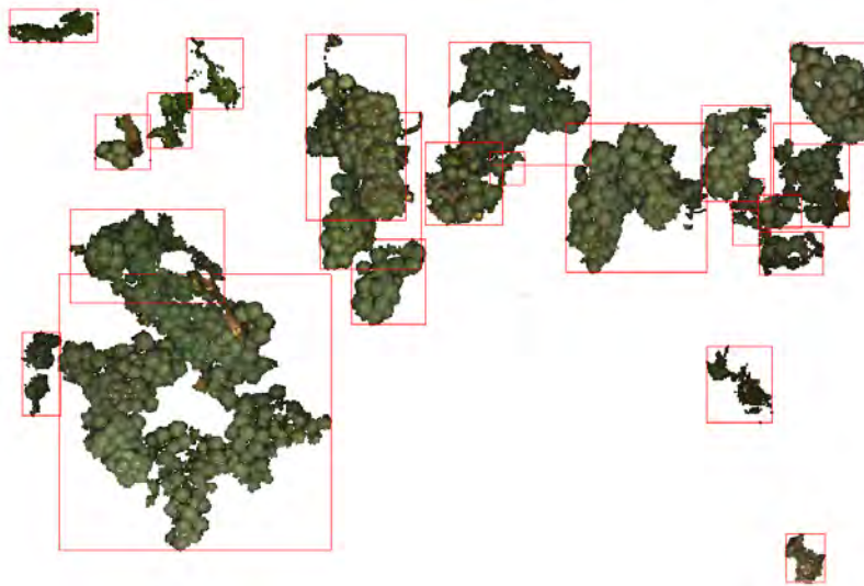
Abbildung 4.26: Durch das CC-Verfahren generierte Komponenten, umrahmt durch eine rote Bounding Box. Die Traubenkandidaten im unteren linken Teil des Bildes konnten nicht weiter räumlich separiert werden und werden zu einer einzigen Komponente zusammengefasst. Im unteren rechten Bild sind beispielhaft einige Fehlklassifikationen erkennbar, die nicht durch p_K gefiltert werden konnten. Im oberen Bereich befinden sich räumlich dicht zusammenliegende, aber individuelle Trauben, die korrekt in einzelne Komponenten unterteilt wurden.
