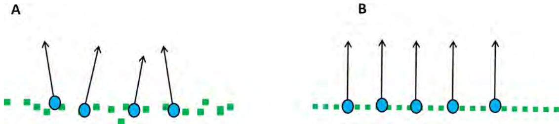
Abbildung 4.7: Grüne Quadrate: 3D-Punkte einer beispielhaften Ebene. Blaue Kreise mit Pfeilen: Normalenvektoren zu beispielhaften 3D-Punkten der Ebene. A: Zufällige Abweichungen der 3D-Punkte von der Soll-Geometrie der Ebene resultieren in Normalenvektoren, deren Ausrichtung nicht dem tatsächlichen Krümmungsverlauf der Ebene entspricht. B: Die Glättung der Oberfläche der Ebene resultiert in parallel zueinander ausgerichteten Normalenvektoren, die dem Krümmungsverlauf der Ebene folgen.
