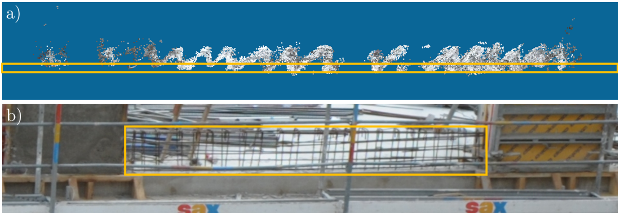
Abbildung 7.1: Rekonstruktion von Bewehrungsstäben bei Szenario \mathcal{T}^{KS} . Die Abbildung zeigt a) eine Draufsicht auf die Punktwolke eines bewehrten Bauteils und b) den dazugehörigen Bildausschnitt, der das Bauteil von vorne zeigt. Der Umriss des Bauteils ist jeweils in orange eingezeichnet.
