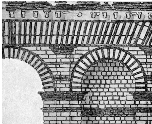
Abb. 17. Abgearbeitete Zwergpilaster auf den Kämpfern der Nischenbögen? Bordeaux, Amphitheater, severisch. Fassade, Ausschnitt. Nach Luigi Crema, L'architettura romana (Enciclopedia classica III/12), Torino 1959, Abb. 662, S. 509.
