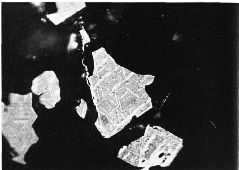
Abb. 12. Erzkorn in der Probe F 4 (Lava von 1950 bei Fornazzo). Die Grundmasse des Erzkornes ist entmischter Titanomagnetit (grau). Deutlich ausgebildete Entmischungs-Lamellen von Ilmo-Hämatit (weiß). Das bedeutet eine Anreicherung des Titans in den Entmischungs-Lamellen und eine Verarmung an Titan in der Grundmasse aus Titanomagnetit (vgl. Petersen 1970). Vergr. 1400 \times , Ölimmersion
