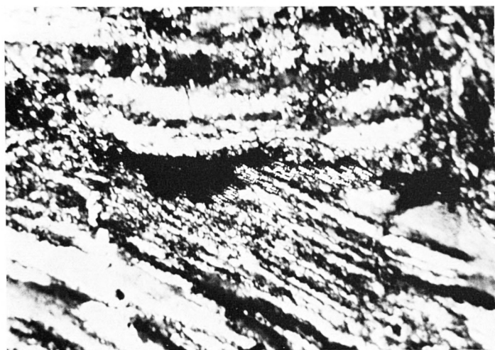
Abb. 19: Dünnschliff-Ausschnitt (Nicols +) aus einem, vermutlich ursprünglich als \text{SiO}_2 -Gel angelagerten Feinquarzit. Die Diskordanz ist, wie außerhalb des im Bild gezeigten Feinquarzits erkennbar ist, durch Zerschörung (und Faltung) der feinschichtig plattenförmigen Gebilde zustande gekommen. Feinquarzit weiß bis grauschwarz. Ausbrüche in Bildmitte und rechts Mitte schwarz. Natürliche Größe des Bildausschnittes 2,3 \times 1,5 mm.
