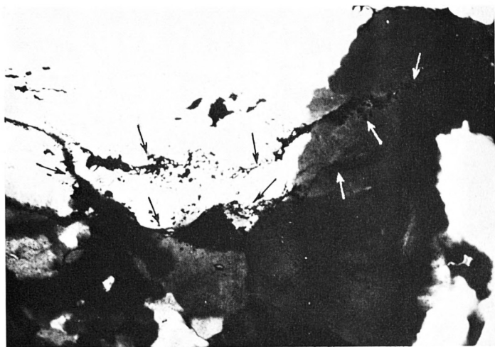
Abb. 18: Annähernd s-parallele Zinnoberanreicherung (Pfeile) im Erzquarzit als Internegefüge si. Quarzkörner (weiß bis grauschwarz, z. T. erkennbar undulös) umwachsen älteren, flächig verteilten Zinnober (schwarz). Dünnschliff, Nicols +. Natürliche Größe des Bildausschnittes 0,87 \times 0,58 mm.
