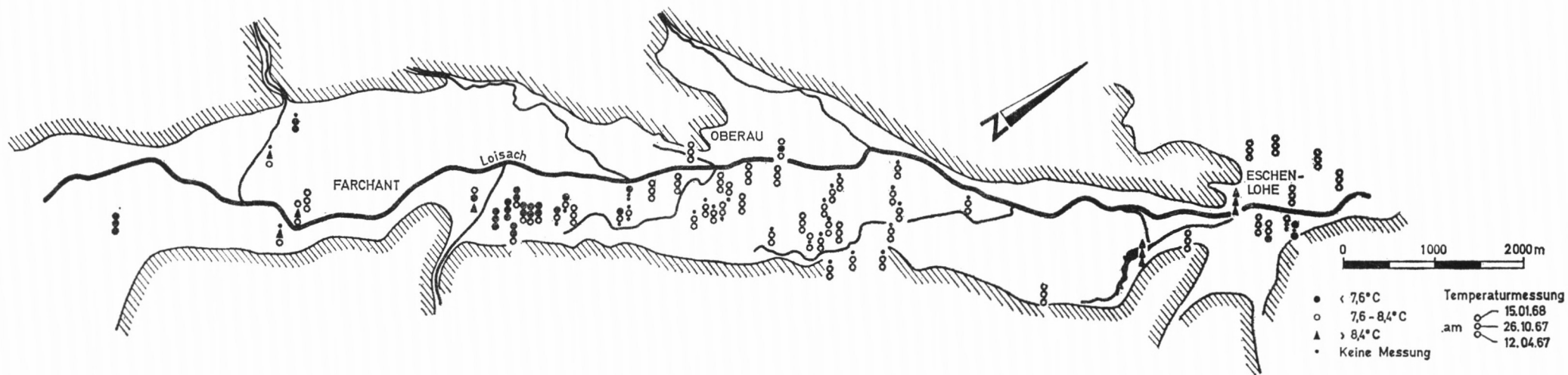
Abb. 29: Temperaturmessungen im 2. Grundwasserstockwerk.
