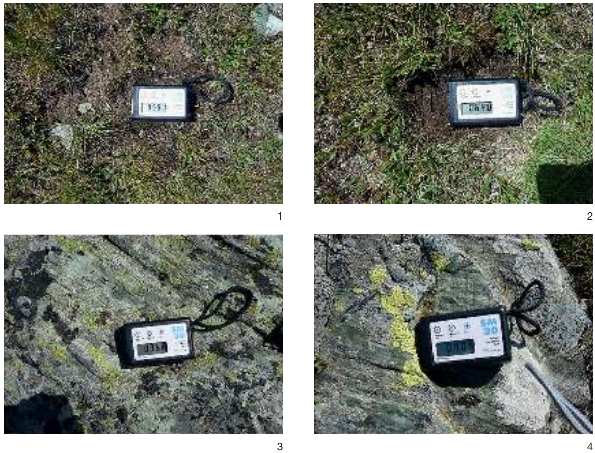
Abb. 2. Septimer. Magnetische Suszeptibilitätsmessungen mit einem Kappameter SM30 ZH instruments. 1–2 Messungen am Oberboden (Lithosol); 3–4 Messungen an anstehendem Grünschiefer. Messwerte, jeweils \times 10[E-3] SI-Units: 1: 0.0591. – 2: 0.0648. – 3: 0.358. 4: 0.405.
