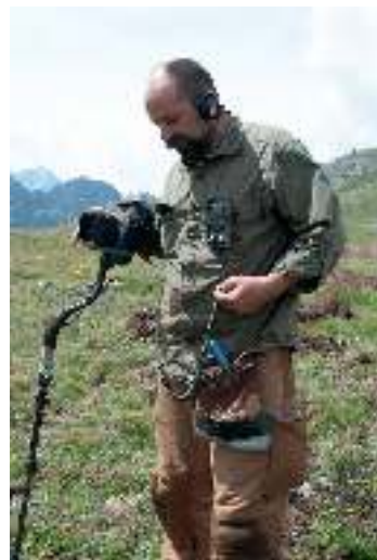
Abb. 32. Septimer. 1–3 Bei der Prospektion verwendete Geräte: Metalldetektor der Marke „XP Gold Maxx 18 kHz“ (1); Spule „Doppel D-27Zoll“ (2); Pinpointer „Pocket Uniprobe, Detectopro“ in Pulsinduktionstechnik (3) (01.08.2008). – 4 Sondengänger Alfred Gilch mit seiner Suchausrüstung (01.08.2008). 5 Studentischer Mitarbeiter (links) bei der Dokumentation eines georteten Metallfundes (23.07.2008).
