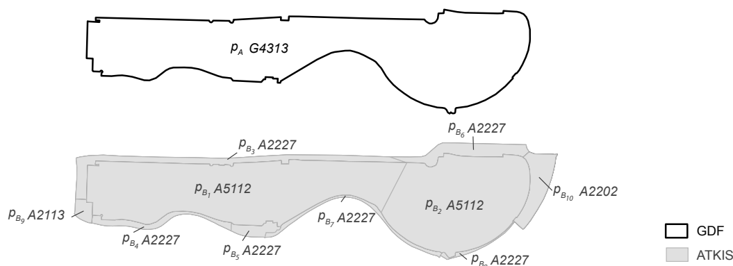
Abbildung 4.3: Bildung einer komplexen Objektrelation zwischen dem schwarz umrandeten GDF-Objekt von Datensatz A und den grauen ATKIS-Objekten aus Datensatz B durch die Zusammenfassung von Nachbarobjekten unter Berücksichtigung ihrer Objektklassen. Zur Bewahrung der Übersichtlichkeit, werden die sich überlagernden Objekte beider Datensätze räumlich getrennt dargestellt. Erläuterungen zu den vorliegenden Objektklassen sind im Anhang in der Übersichten C.1 und C.2 zu finden.
