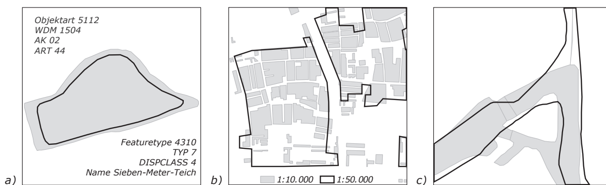
Abbildung 2.4: Probleme bei der Objektzuordnung: a) geometrische Unterschiede hinsichtlich Position, Objektform und -größe, aber auch bzgl. der Attributinformatoren, b) unterschiedliche Maßstäbe können zu komplexen Objektrelationen (1:n/n:1 bzw. n:m) führen und c) unterschiedliche Geometriedimensionen (Polygon- und Linienobjekte)
