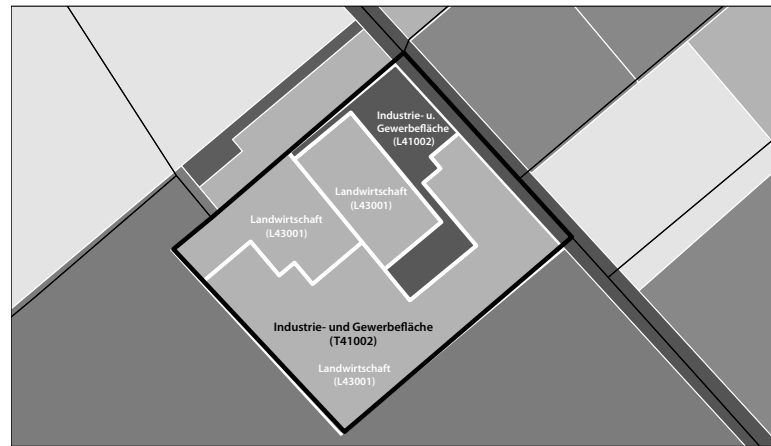
Abbildung 6.3: Überlagerung der Beispieldaten ALKIS (gefüllte Polygone mit starken weißen Konturen) und ATKIS (nicht gefüllte Polygone mit schwarzen Konturen) im Testgebiet B. Die zugehörigen Objektklassen sind mit unterschiedlichen Schriftfarben gekennzeichnet: ALKIS (weiß) und ATKIS (schwarz).
