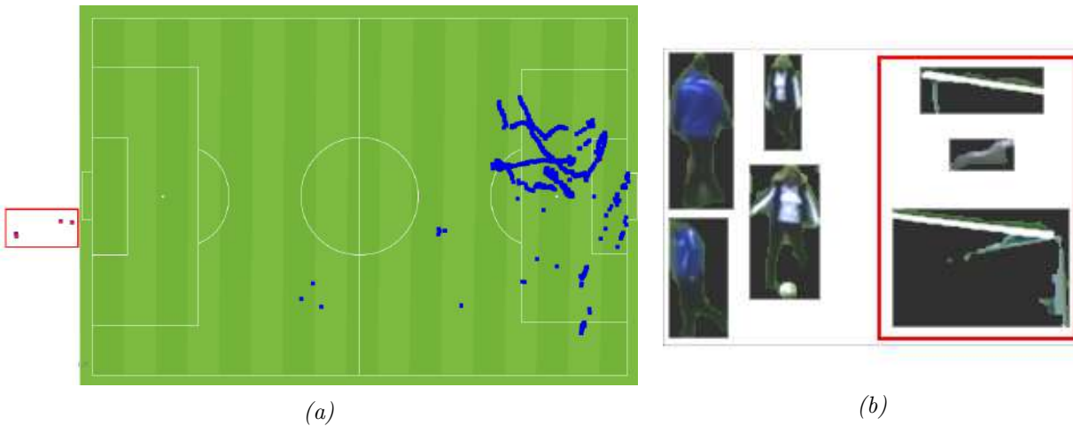
Abbildung 4.3: Bei der räumlichen (a) und geometrischen Filterung (b) der Detektionen werden jeweils die in rot eingrahmten Detektionen als Fehldetektionen angesehen und verworfen. In a) sind hierbei die Detektionen durch blaue Kästchen dargestellt. In b) werden die Bildregionen der Detektionen gezeigt.
