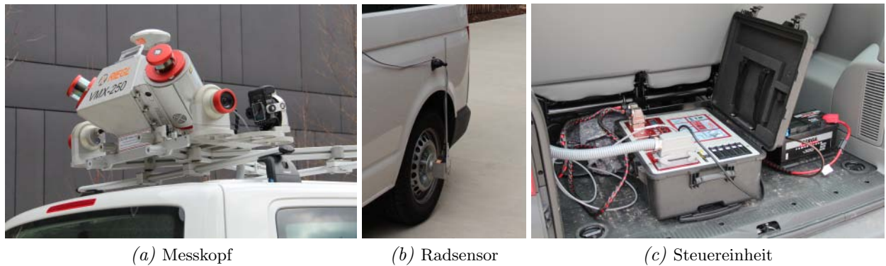
Abbildung 2.1.: Das Mobile Mapping System RIEGL VMX-250: Messkopf mit zwei Laserscannern sowie vier (optionalen) Kameras zur Umgebungserfassung und GNSS/INS-Einheit zur Positionierung. Radsensor zur Verbesserung der Positionierung. Steuereinheit mit PC zur Datenerfassung und Speicherung.
