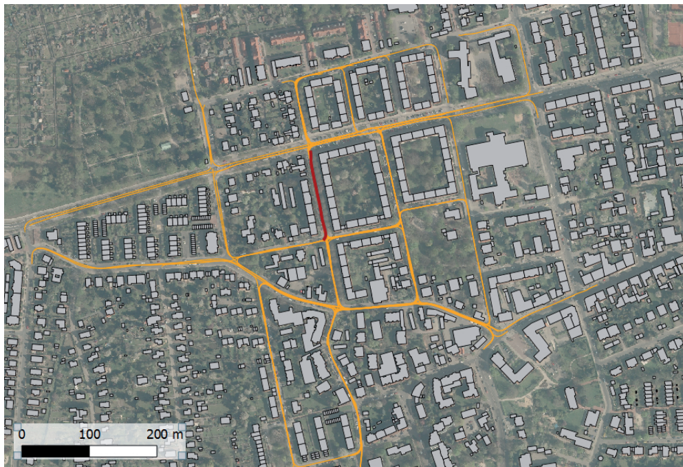
Abbildung 7.1.: Trajektorien im Testgebiet zur Auswertung mit Referenzdaten. Gelb: Trajektorien von 150 Scanstreifen. Rot: Trajektorie der ausgewählten Epoche zur detaillierten Evaluation. (Orthophoto und Gebäude: LGLN)
