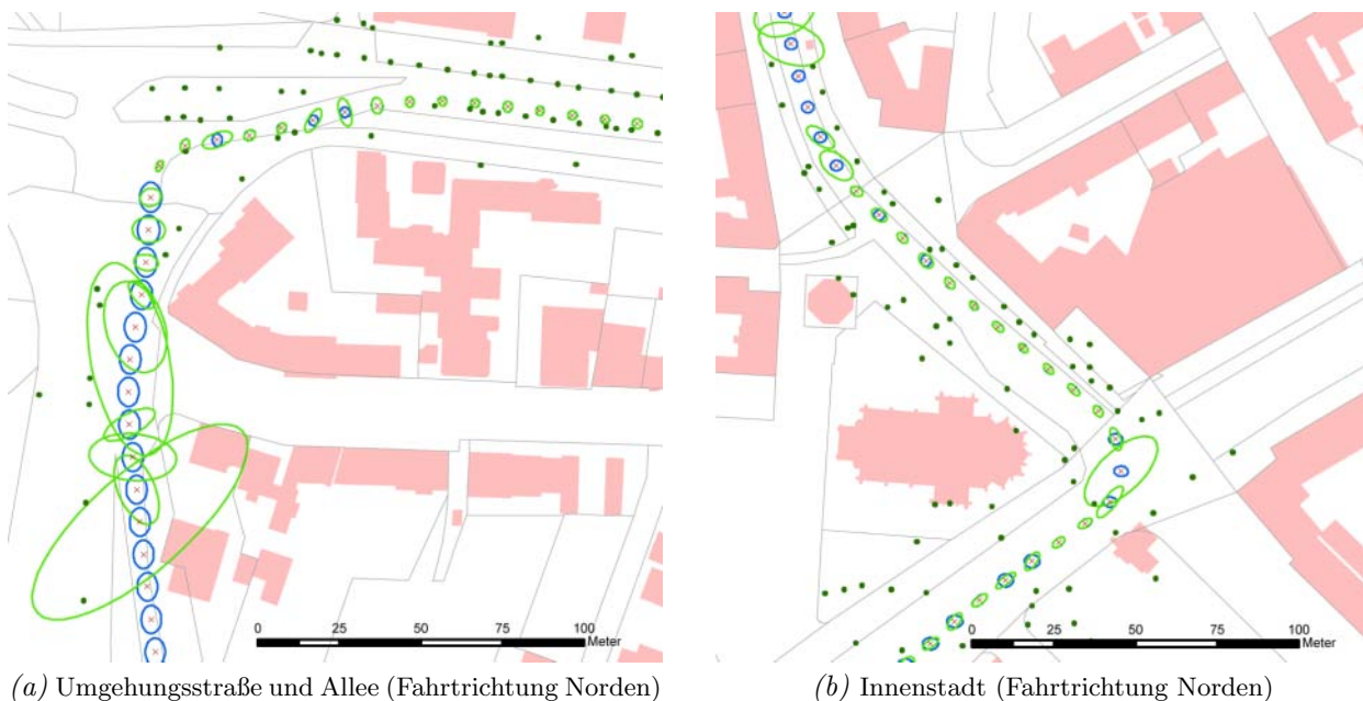
Abbildung 4.12.: Positionierungsgenauigkeit für die Simulation: Einzelpositionen (grün), mit Filter (blau), georeferenzierte Stangen als Landmarken (grüne Punkte). Alle Ellipsen mit Faktor 20 vergrößert, blaue Ellipsen teilweise durch grüne überlagert, nach Hofmann u. a. (2011).
