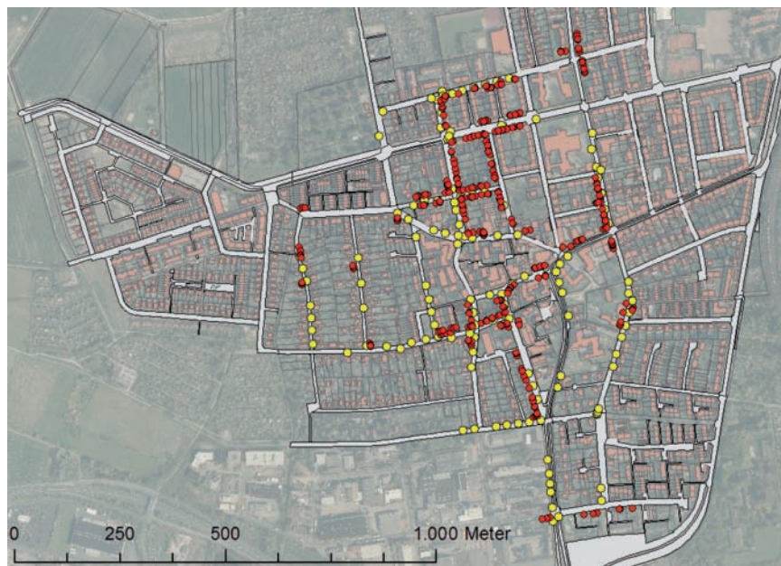
Abbildung 5.13.: Verteilung der Referenzobjekte auf Fassaden (rote Punkte) und Masten von Straßenbeleuchtung (gelbe Punkte). Orthophotos, Grundrisse und Straßenflächen: LGLN.
