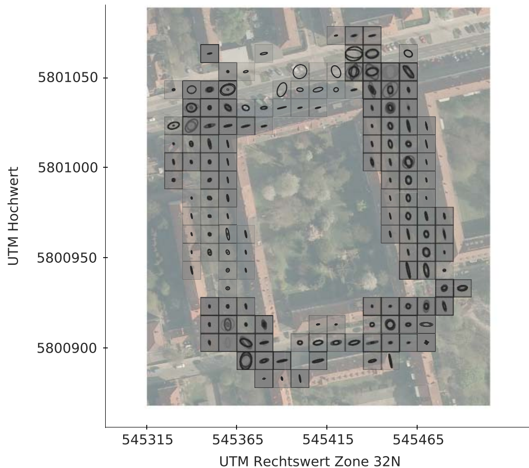
Abbildung 5.6.: Darstellung der Qualität des ICP-Algorithmus auf Basis der Normalenrichtungen (x,y) in den Punktwolken für jede Kachel. Ergebnis aus den Kofaktormatrizen des ICP-Algorithmus (Seitenlänge 10 m, Ellipsen skaliert mit Faktor 10).
