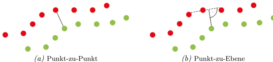
Abbildung 2.5.: Verschiedene Möglichkeiten der Zuordnung korrespondierender Punkte aus zwei Punktwolken für den ICP-Algorithmus mit Referenz- (rot) und transformierter Punktwolke (grün).
