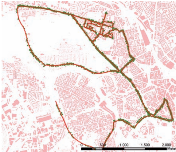
Abbildung 4.8.: Verteilung von zylindrischen Landmarken entlang der untersuchten Trajektorie, Hofmann u. a. (2011).
