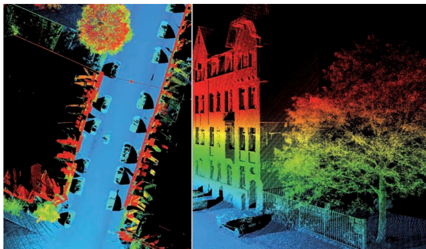
Abbildung 2.3.: Punktwolke einer Straße mit Fassaden, geparkten Fahrzeugen parallel zur Fahrbahn und einem Baum, eingefärbt nach der Höhe der Punkte über Grund. Aufsicht als 2D-Darstellung (links) und mit Blickrichtung nach Süden in 3D-Darstellung (rechts).
