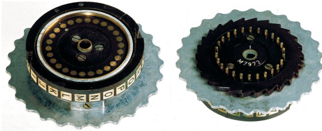
Abb. 1. ENIGMA-Rotor (Vorderseite und Rückseite).
