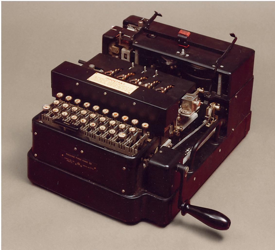
Abb. 5. Britische Chiffriermaschine Typex Mark III .
