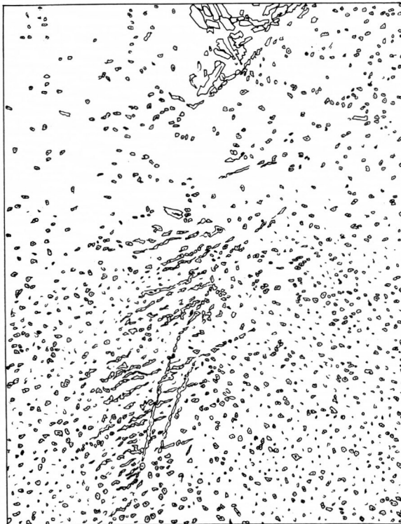
Abb. 1: Titanitfleckenredwitzit: Von oben greift eine Kalifeldspatapophyse des porphyrischen Granits in den Redwitzit. Sie geht nach unten in aplitisches gefüllte Fiederspalt über, die große Titanite führen. Das Bild zeigt eindeutig, daß die Titanitfleckenbildung eine Folge des Granitkontaktes ist. Nordteil des Steinbruches Grafenstein/Bl. Marktredwitz: R 45 08,30; H 55 44,90.
