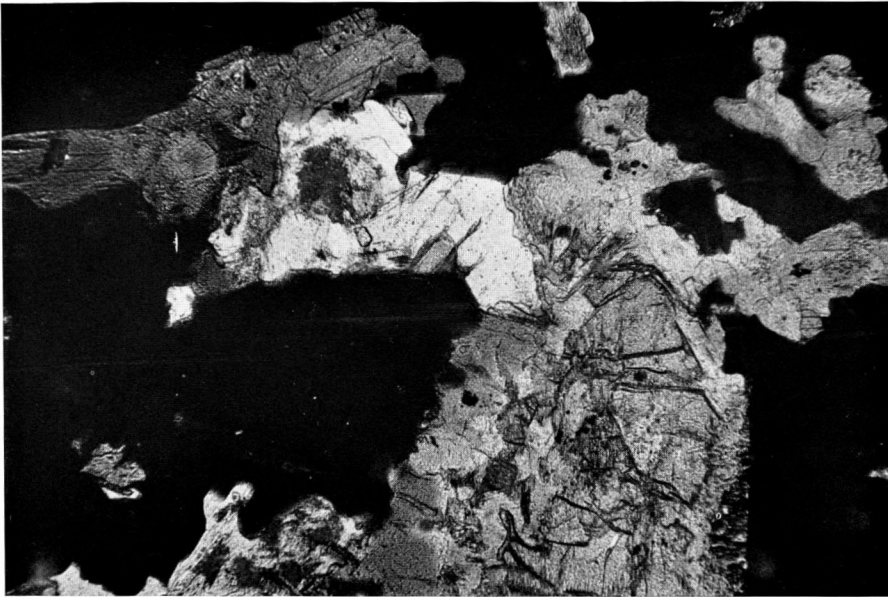
Abb. 1: Schliff Nr. 4287, 1 Nicol. Vergr. 80-fach. Hornblende (grau) verdrängt Hypersthene (rechts unten) und Biotit (schwarz). Gegenüber Biotit bildet die Hornblende zuweilen eine verzahnte Grenze (rechts unten) aus. Basischer Redwitzit, Steinbruch Wölssauer Höhe.
