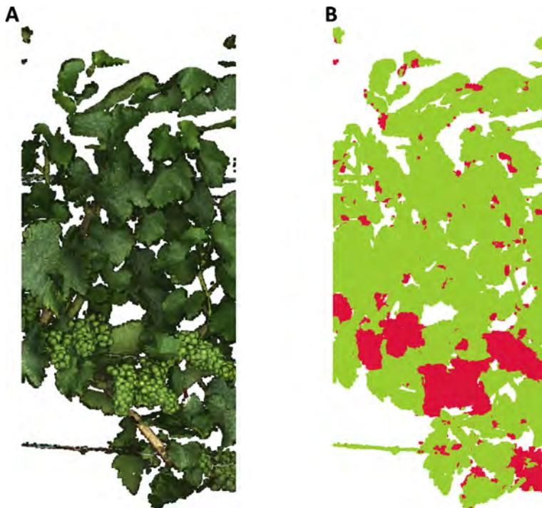
**Abbildung 4.15:** **A:** Testdaten in RGB-Farben. Die Maße des Ausschnitts betragen rund  $40 \times 100 \times 60 cm$ . Trauben und Blätter sind sich farblich sehr ähnlich und in einem durchgehend hellgrünen Farbton. **B:** Das Klassifikationsergebnis mit SFHc-Deskriptoren für  $r_n = 2mm$ ,  $r_H = 14mm$ . Rot: Trauben; Grün: Rest
