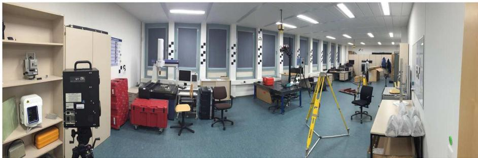
Abbildung 3.8: Versuchsaufbau im Messlabor der FhG zur Untersuchung der Abhängigkeit der Messunsicherheit vom Auftreffwinkel
