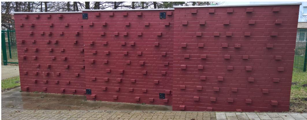
Abbildung 4.1: Messwand als Testkörper in Anlehnung an ein Stufennormal
