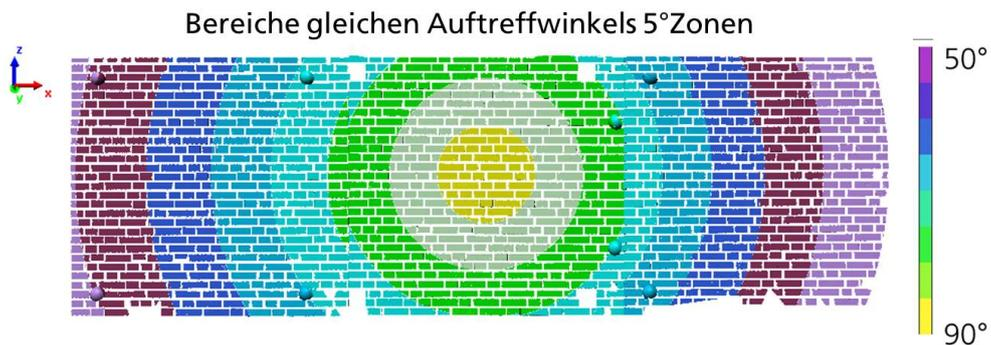
Abbildung 4.4: Einteilung des Prüfkörpers entsprechend des Auftreffwinkels [GEIST et al., 2013]
